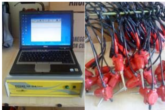
Fig. 5.1.4.I: Da sx a dx sismografo Echo con annesso computer, geofoni verticali R.T.Clark da 4.5 Hz, cablaggi e massa battente.
